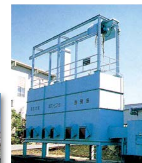
乾式脱臭装置
